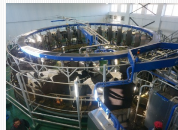
↑ 中標津町・希望農場のロータリーパーラー型搾乳ロボット
